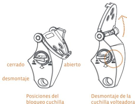
**ATENCIÓN** Maneje esta pieza con mucho cuidado ya que se podría cortar. Las piezas soporte, cuchilla volteadora y bloqueo, deben desmontarse y montarse de la máquina siempre en conjunto.
